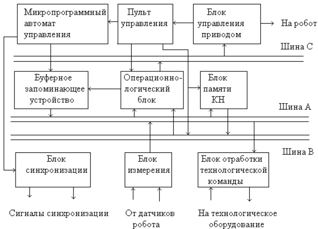
Рис. 5.7. Схема централизованной структуры позиционной системы программного управления.
